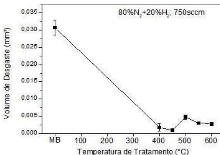
Quando se aumenta o fluxo de gás de 500 para 750 sccm, aumentou-se o volume de desgaste de 0,0008 mm<sup>3</sup> para 0,004 mm<sup>3</sup>. Isso ocorre devido ao potencial de nitrogênio que aumenta no ambiente de tratamento, causando um aumento de espessura da camada, a qual se torna frágil e se quebra com facilidade, acentuando o processo de desgaste devido aos detritos formados.
