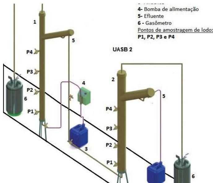
O tempo de detenção hidráulico (TDH) foi de 48 e 96 horas para o R1 e o R2, respectivamente. Durante a fase 1 foi usada a proporção de 50% de ARBL e 50% de ARC com a recirculação do efluente. Na fase 2 essa proporção foi de 70% de ARBL e 30% de ARC também com a recirculação do efluente.
