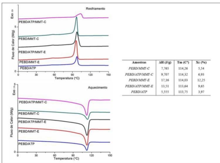
Figura 1- Curvas DSC do PEBD/ATP e suas blends, nas condições: (a) curvas de resfriamento (b) segundas curvas de aquecimento.
