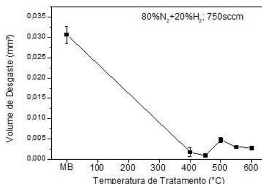
Figura 1 – Volume de desgaste em função da temperatura
