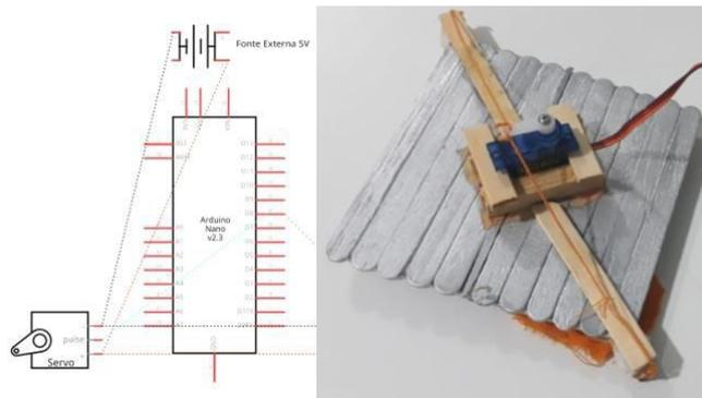
Os testes com o 1º lançador foram feitos com carga simulada composta por uma porca e uma arruela metálicas cada alçapão – cerca de 15 gramas em cada conjunto, relativo ao peso estimado dos sensores meteorológicos que serão utilizados em testes com o VANT.
