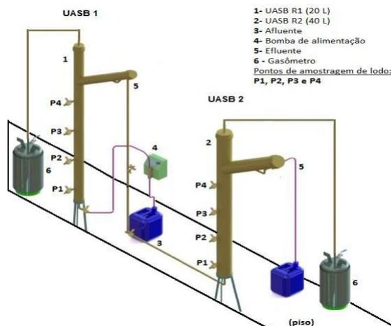
FIGURA 1. Vista do sistema anaeróbico composto pelos reatores UASB (R1 e R2), em série.
