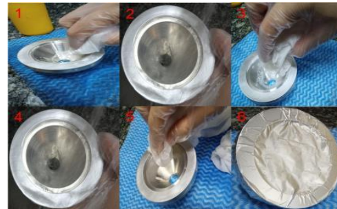
Figura 2 – Etapas de limpeza dos componentes sistema tubular. 1- Detergente alcalino; 2- Enxágue; 3- Detergente neutro; 4- Enxágue; 5- Álcool isopropílico; 6- Embalagem.
