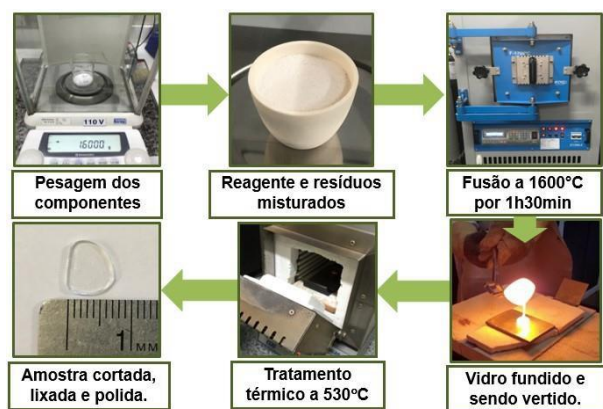
Figura 2 - Fluxogramas do processo de fabricação do vidro produzido a partir dos resíduos beneficiados.
