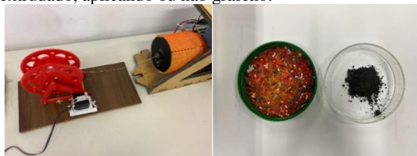
Figura 03 – Filamento de PLA puro ou reciclado sendo extrudado, aplicando ou não grafeno.
