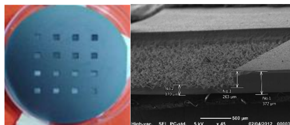
Figura 04 - a) Imagem das 16 membranas após o processo de ablação a laser, b) Imagem MEV de uma das membranas.
