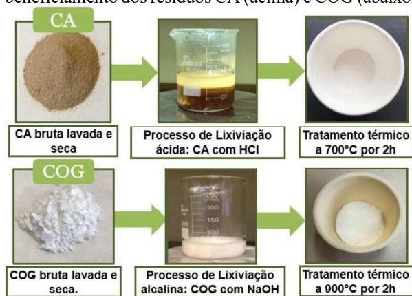
Figura 1 - Fluxogramas simplificados do processo de beneficiamento dos resíduos CA (acima) e COG (abaixo).
