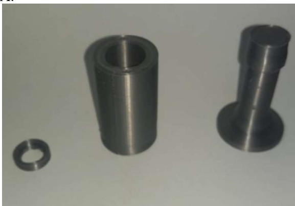
Figura 04 – Protótipo do adaptador para o TL-4 em PLA.
