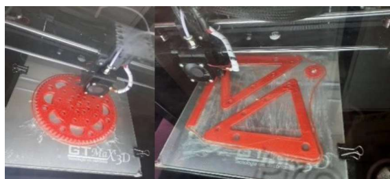
Figura 02 – Produção das peças do mecanismo por meio da impressora 3D GTMax3D
