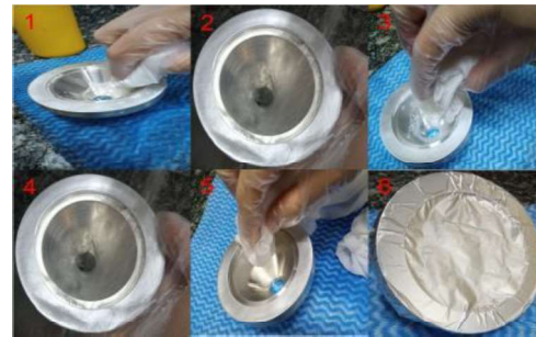
Figura 2 – Etapas de limpeza dos componentes sistema tubular. 1- Detergente alcalino; 2- Enxágue; 3- Detergente neutro; 4- Enxágue; 5- Álcool isopropílico; 6- Embalagem.
