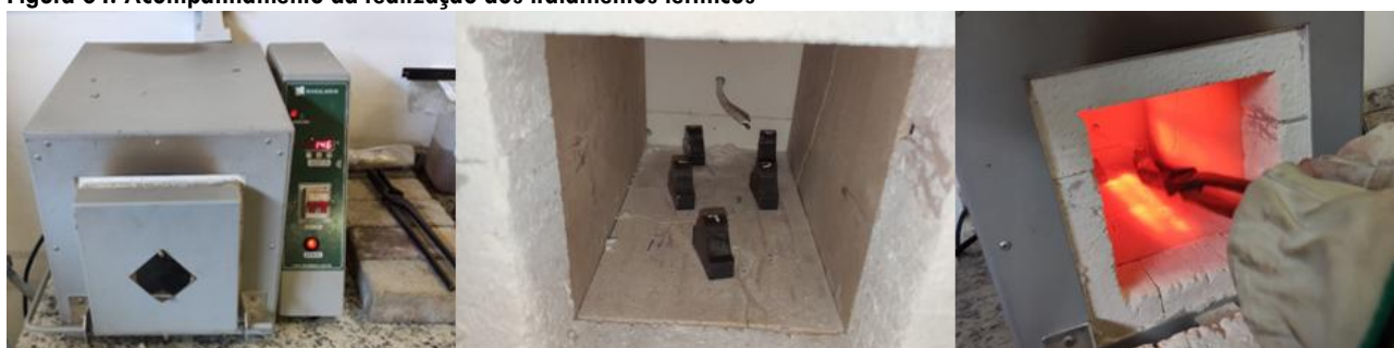
Figura 04: Acompanhamento da realização dos tratamentos térmicos
