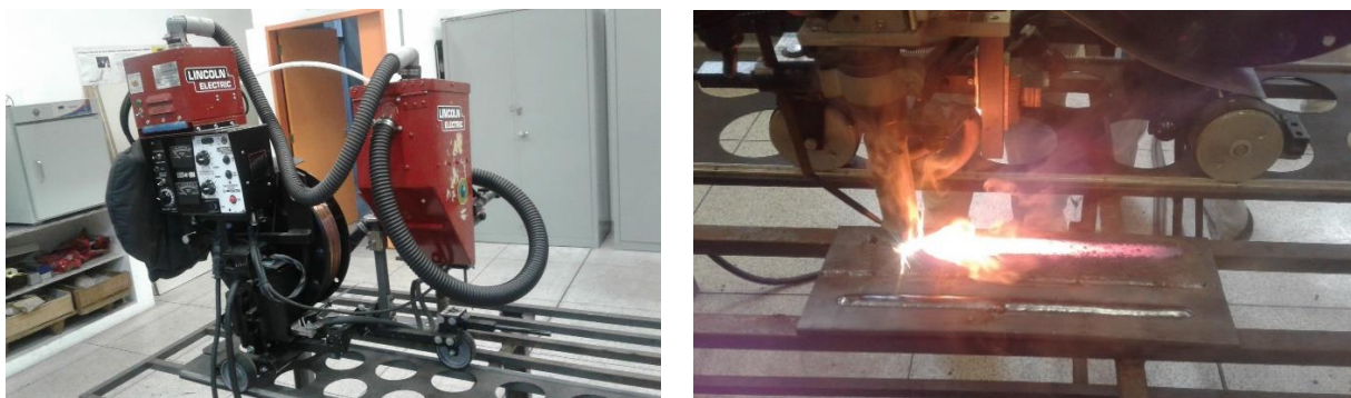
Figura 2 – Operação do sistema de soldagem por arco submerso (SAW)
