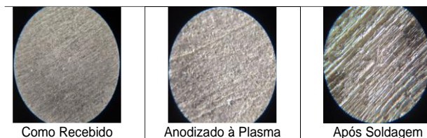
Figura 02 — Macrografia (100X) das amostras após ensaio potenciodinâmico
