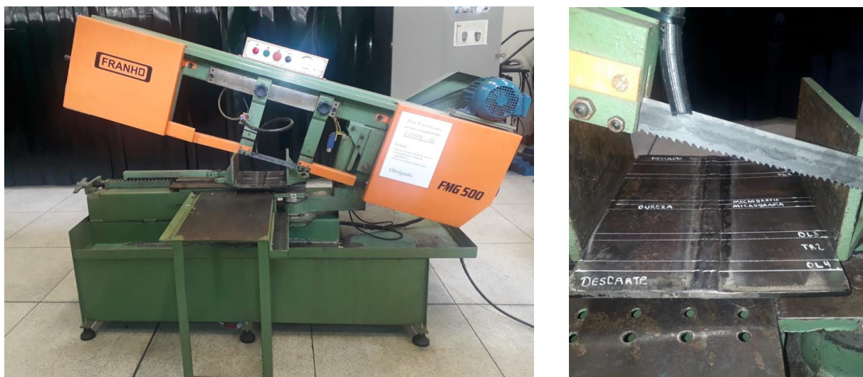
Figura 6 – Serra FRANHO e corte dos corpos de prova
