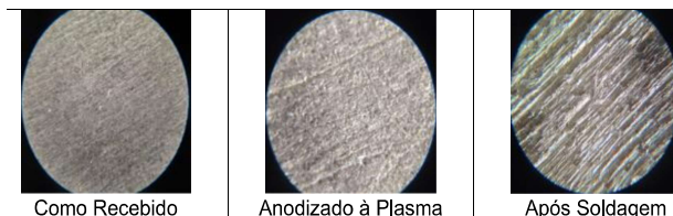
Figura 02 — Macrografia (100X) das amostras após ensaio potenciodinâmico
