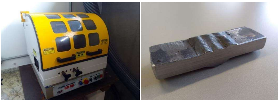
Figura 7 – Preparação e corte da secção menor na Cut-Off
