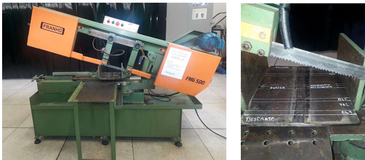
Figura 6 – Serra FRANHO e corte dos corpos de prova
