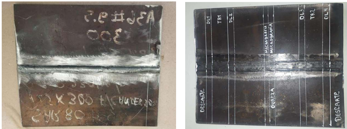
Figura 5 – Chapa teste para a qualificação do procedimento de soldagem
