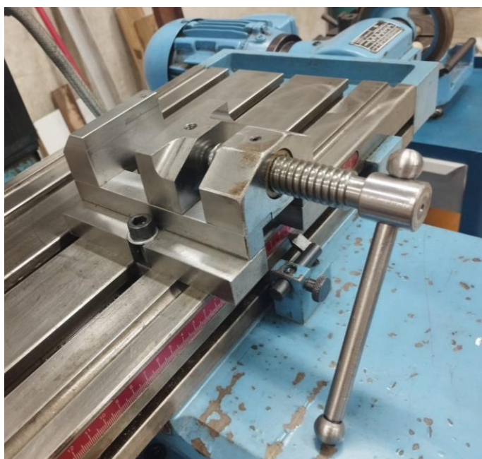
Figura 2 – Morsa com base adaptada para fixação em furadeira de bancada.
