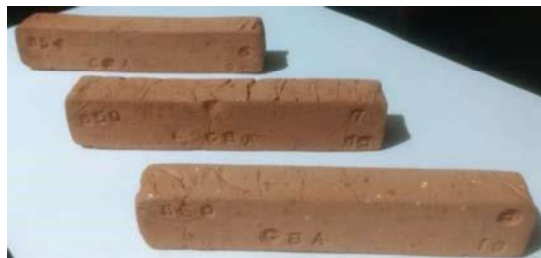
Figura 3. Corpo de prova do Tijolo Bayer
